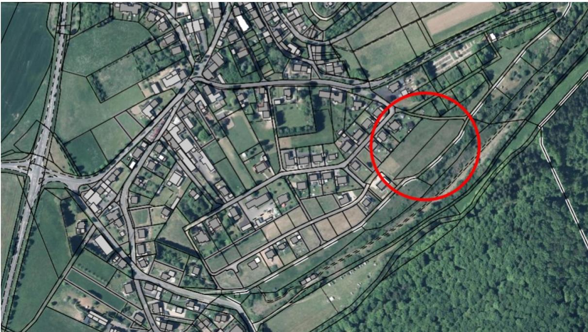
Die Entwässerung des Gebietes ist aufgrund der Topografie im Trennsystem (Auf dem Kutschweg) und Mischsystem (Schulstraße) vorgesehen. Der Schmutz- und Mischwasserkanal soll in duktilem Gusseisen DN 200 und 300 und der Regenwasserkanal in PVC DN 300 verlegt werden. Die Erschließung erfolgt bei beiden Systemen in freiem Gefälle an die vorhandene Ortskanalisation.
