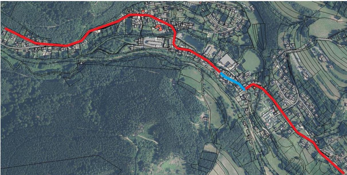
Im Ausbaubereich ist vorgesehen, den Regenwasserkanal DN 300 auf einer Länge von 170 m zwischen der Müllenborner Str. 40 und 56 zu erweitern bzw. neu zu verlegen (siehe blaue Linie in der Kartierung). Vereinzelt wird auch die Erneuerung von Kanalhausanschlüssen erforderlich. Punktuell ist zudem der Rückbau von Schächten vorgesehen. Von den 65 vorhandenen Schachtbauwerken können 11 rückgebaut und aufgegeben werden, sodass noch 54 Abdeckungen für die verbliebenen Bauwerke zu erneuern sind.
