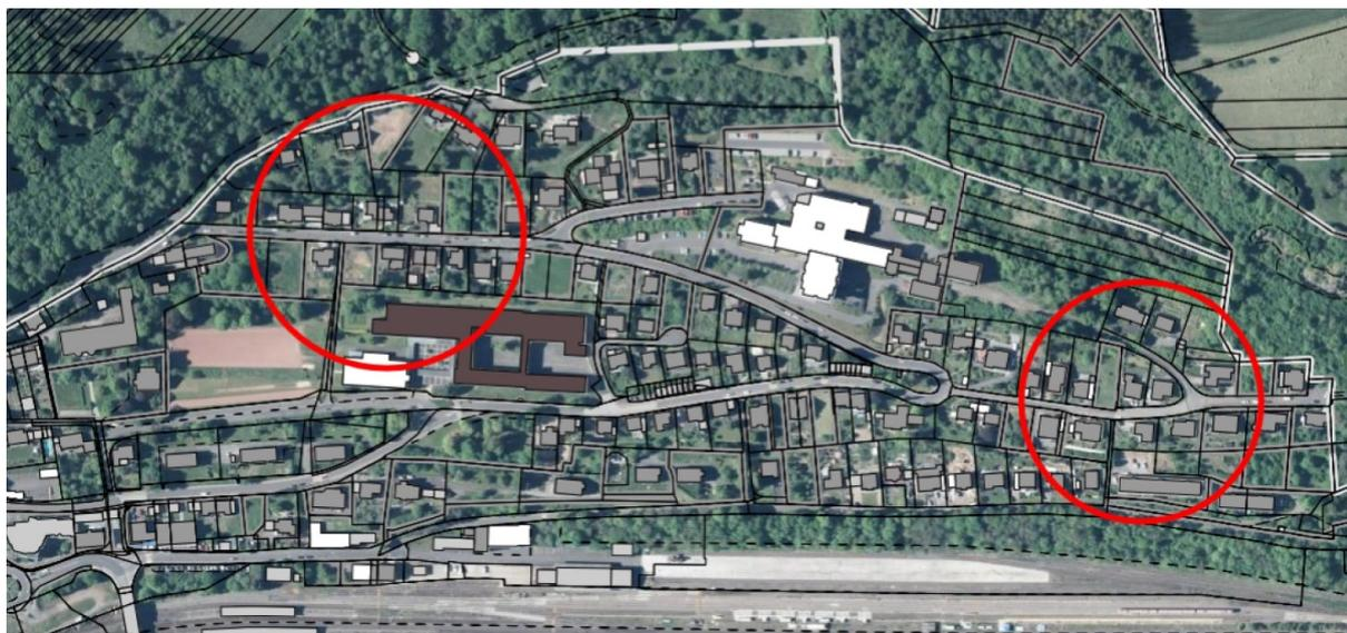
Es ist vorgesehen, die Wasserleitungen auf einer Länge von rd. 475 m in duktilem Gusseisen DN 100 neu zu verlegen. Vereinzelt sind auch Wasserhausanschlüsse zu erneuern. Zudem werden die beschädigten Kanalausanschlüsse erneuert und der Mischwasserkanal DN 300 punktuell in offener Bauweise saniert. Die Erneuerung der Hauptkanäle findet durch die parallel arbeitende Kanalsanierungsfirma statt.
