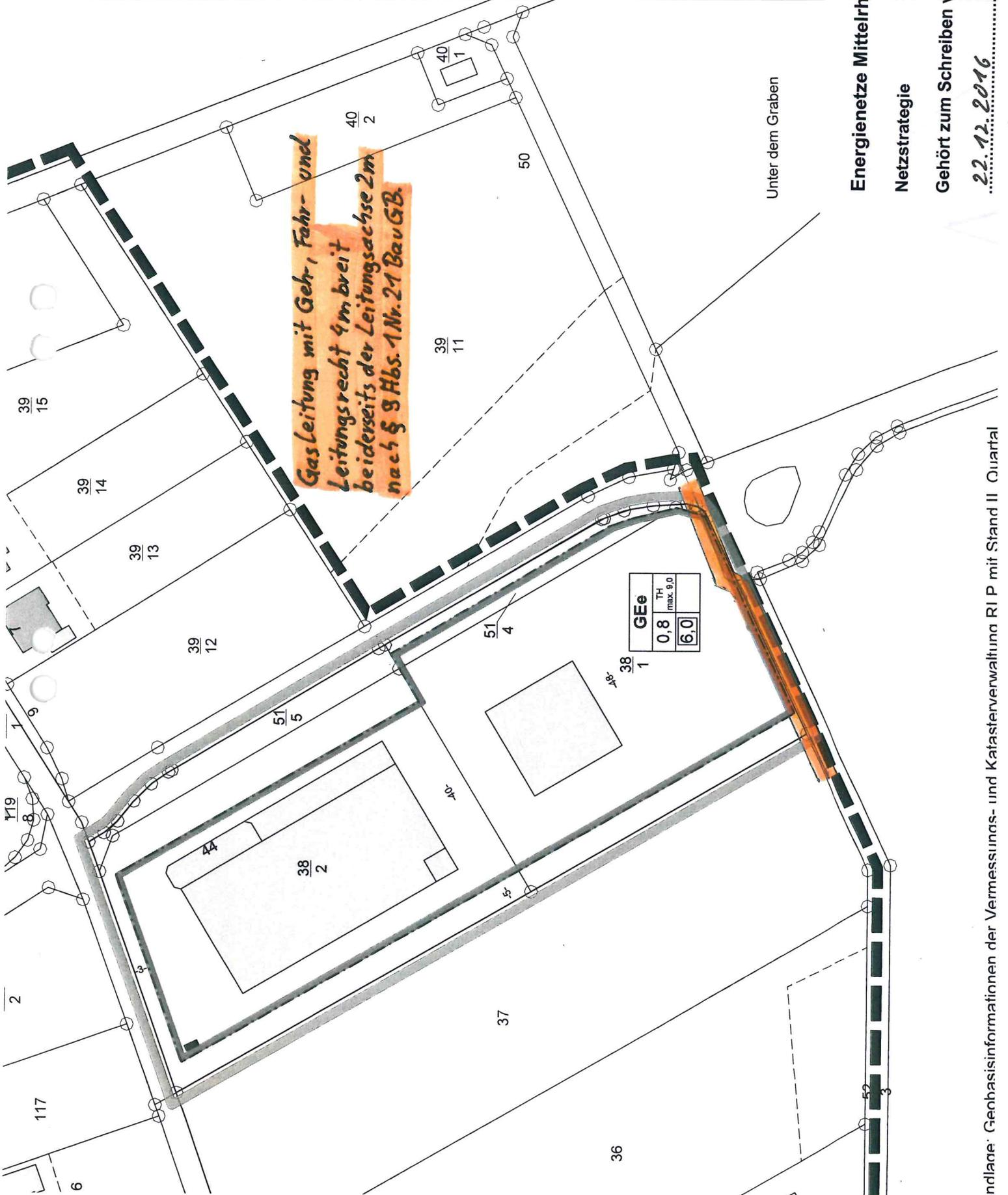
*Gasleitung mit Geh-, Fahr- und Leitungsrecht 4m breit beiderseits der Leitungsachse 2m nach § 9 Hbs. 1 Nr. 21 BauGB.*
