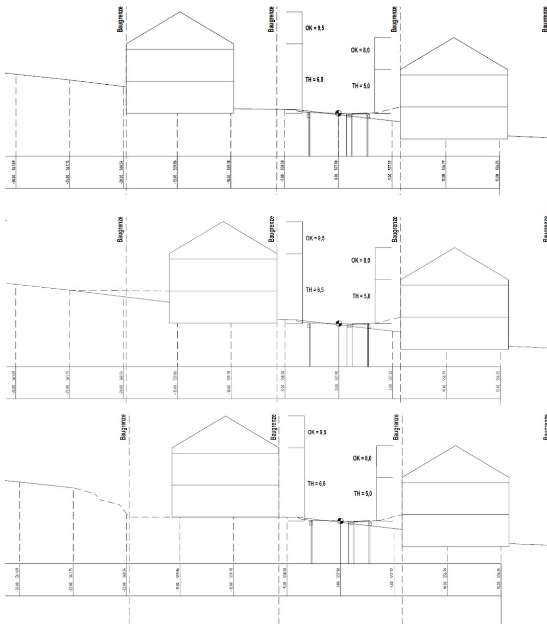
Abbildung 6: Systemschnitt zur Veranschaulichung der Höhenfestsetzungen, Möglichkeiten zur topographieangepassten Bauweise
