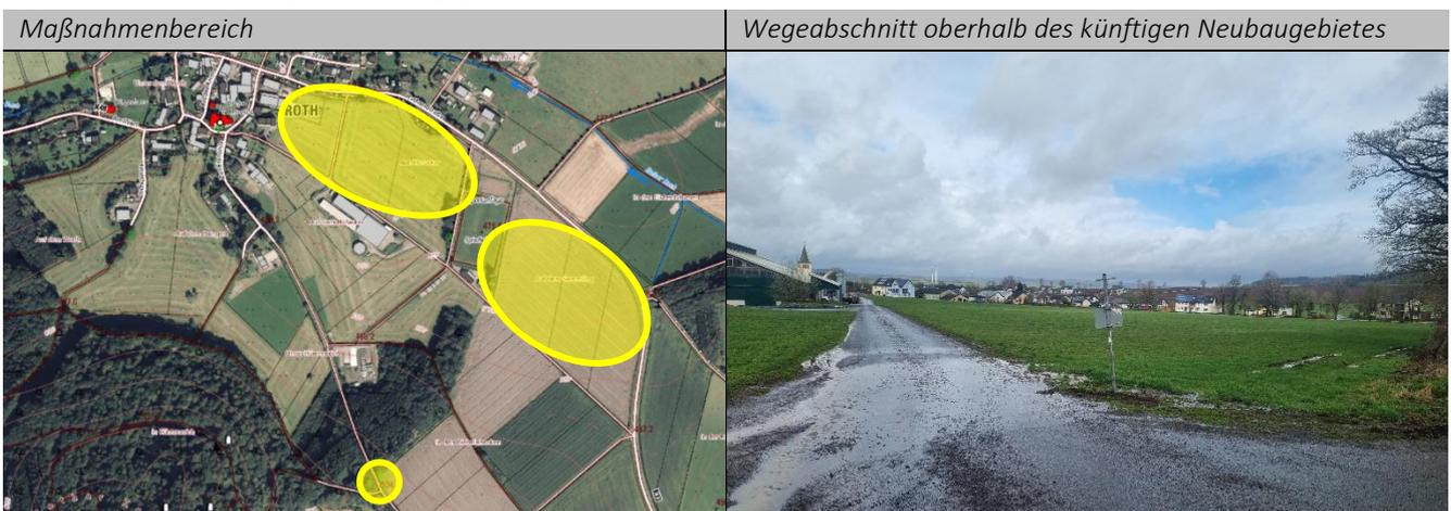
Gefährdung des Ortskerns durch den konzentrierten Eintrag von Oberflächenabfluss zu vermeiden. Optionen zur sukzessiven Rückhaltung bieten beispielsweise kaskadenartig angelegte Mulden zwischen dem parallel zur Kreisstraße verlaufenden Weg und der zu bebauenden Fläche, sodass die Beaufschlagung der Grabenentwässerung möglichst gedrosselt erfolgt.
