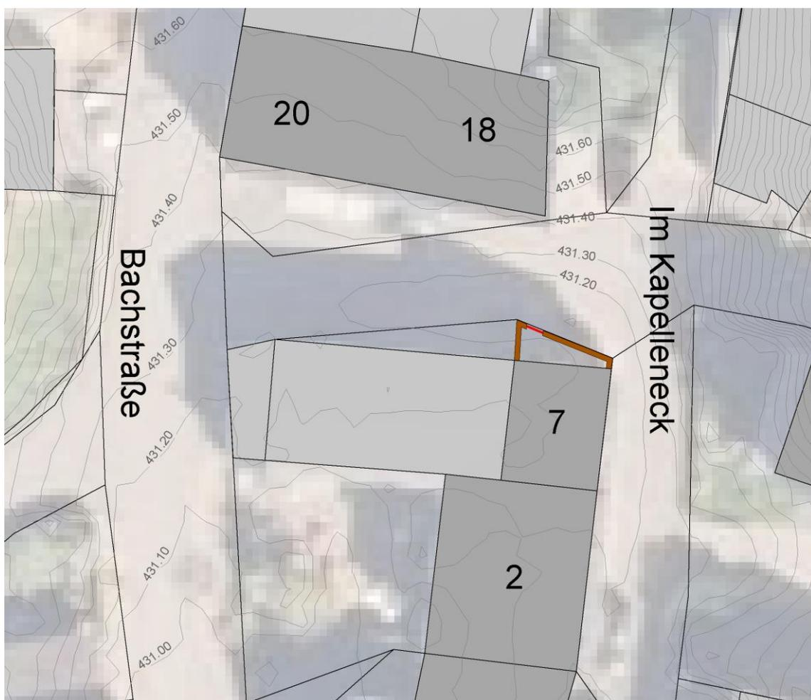
Abb. 6: Geplante Hochwasserschutzmauer Im Kapelleneck Nr. 7
