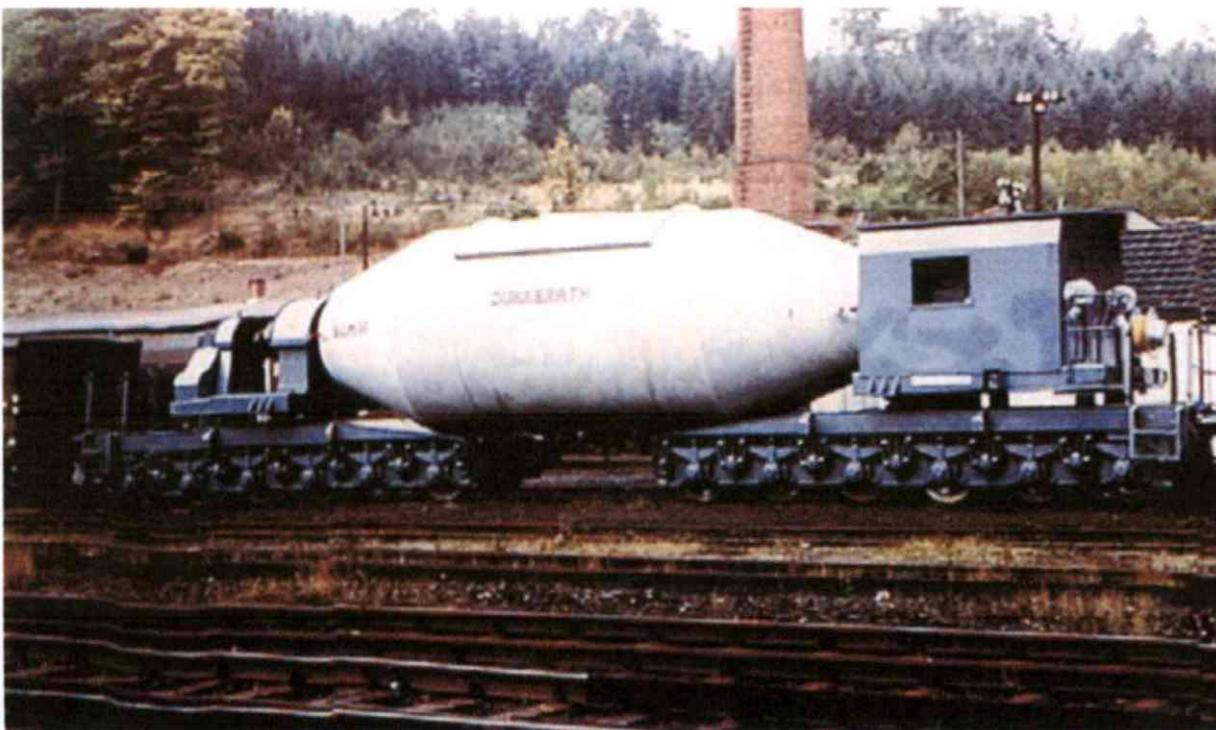
Ein Torpedowagen für den Transport von 300 to. Flüssigeisen.
