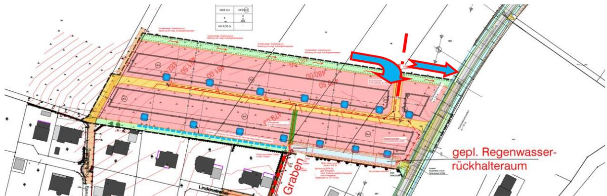
Sofern aufgrund von anhaltendem Starkregen das Volumen des Regenrückhalteraumes vollständig gefüllt ist, wird der Notwasserweg im Bereich der Drosseleinrichtung vorgesehen. Neben dem Drosselbauwerk im Bereich des vorh. Grabens wird das Erdbecken so profiliert, dass ein „Überlaufen“ an dieser Stelle stattfindet.
