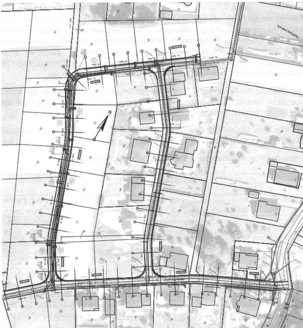
Die Entwässerung des Baugebietes ist im Trennsystem vorgesehen. Der Schmutzwasserkanal soll auf einer Länge von rd. 260,00 m in GGG DN 250 und der Regenwasserkanal auf einer Länge von rd. 306,00 m in PVC DN 300 und DN 400 verlegt und an die vorhandene Ortskanalisation angeschlossen werden.
