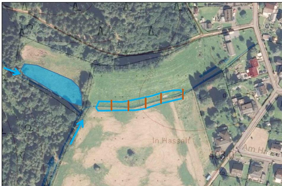
Abb. 14: Aufweitung des Niederbettinger Baches und Einbau von Querriegel sowie Anlage einer Retentionsmulde auf dem alten Sportplatz
