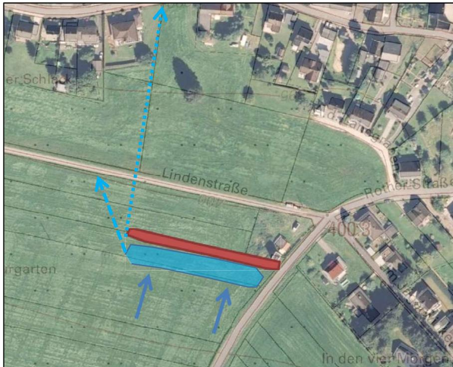
Abb. 13: Erdwall mit vorgelagerter Rückhaltemulde; Drosselablauf in den geplanten Regenwasserkanal in der Lindenstraße, Notabflussweg über Hauptstraße in den Liepach
