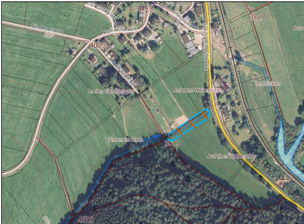
Abb. 15: Aufweitung des Baches vom Wolfsbeuel und Einbau von Querriegel
