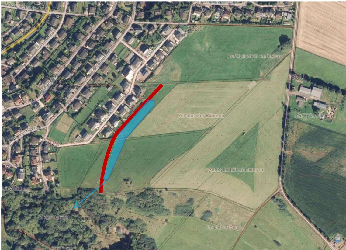
Abb. 13: Vorschlag für Schutz der geplanten Erweiterung des Neubaugebietes im Bereich „Am Kreuz“ in Richtung Süden: Anlage eines Erdwalles mit vorgelagerter Retentionsmulde und Drosselablauf in Regenwasserkanal Richtung Liehrtal
