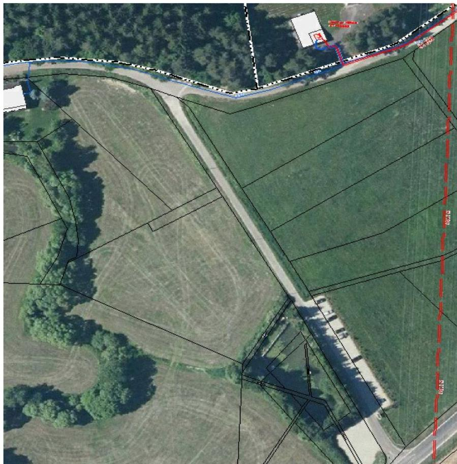
Der Parkplatz ist bisher nicht erschlossen und ist in OF0 (ohne Oberfläche) zu machen. Ein Niederspannungskabel A 150 sollte nicht von dem vorhandenen Niederspannungskable ca. 150 m gelegt werden, sondern als Sonderstromkreis, ca. 230 m, bis zur Parkplatzmitte. Sollte später ein weiterer Verbraucher am Parkplatz hinzukommen (Wohnmobilstellplatz, Schranke usw.) besteht die Möglichkeit diese anzuschließen.
