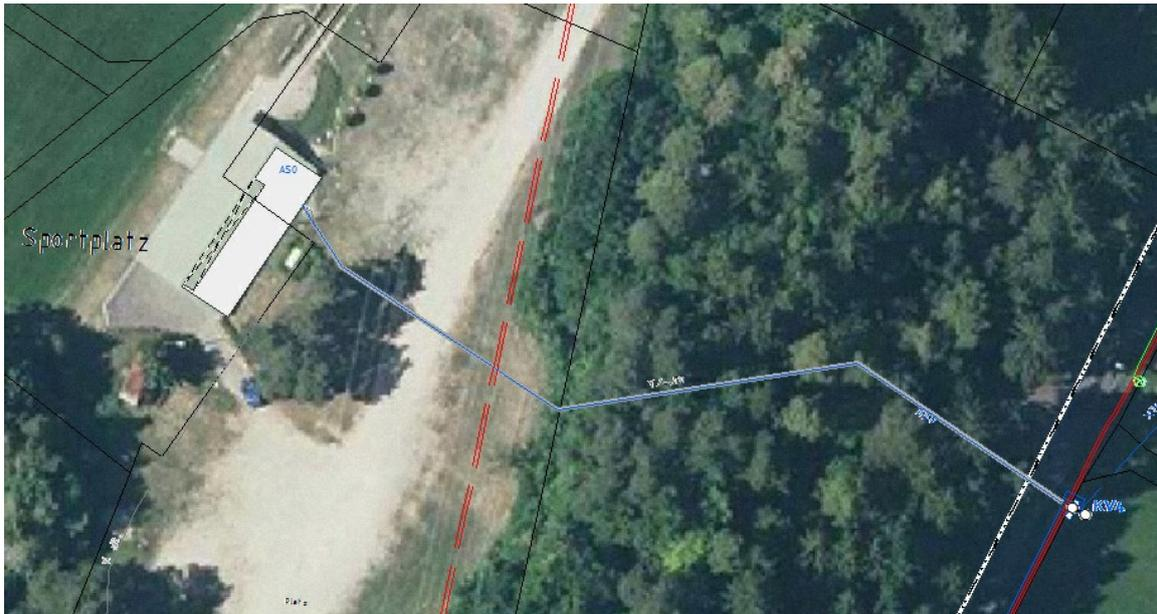
Ein Niederspannungskabel 50<sup>2</sup> liegt bereits zur Erschließung des Sportplatzes und muss gegen ein ca. 120 m, A 150 bei OF= durch ein Waldstück getauscht werden.
