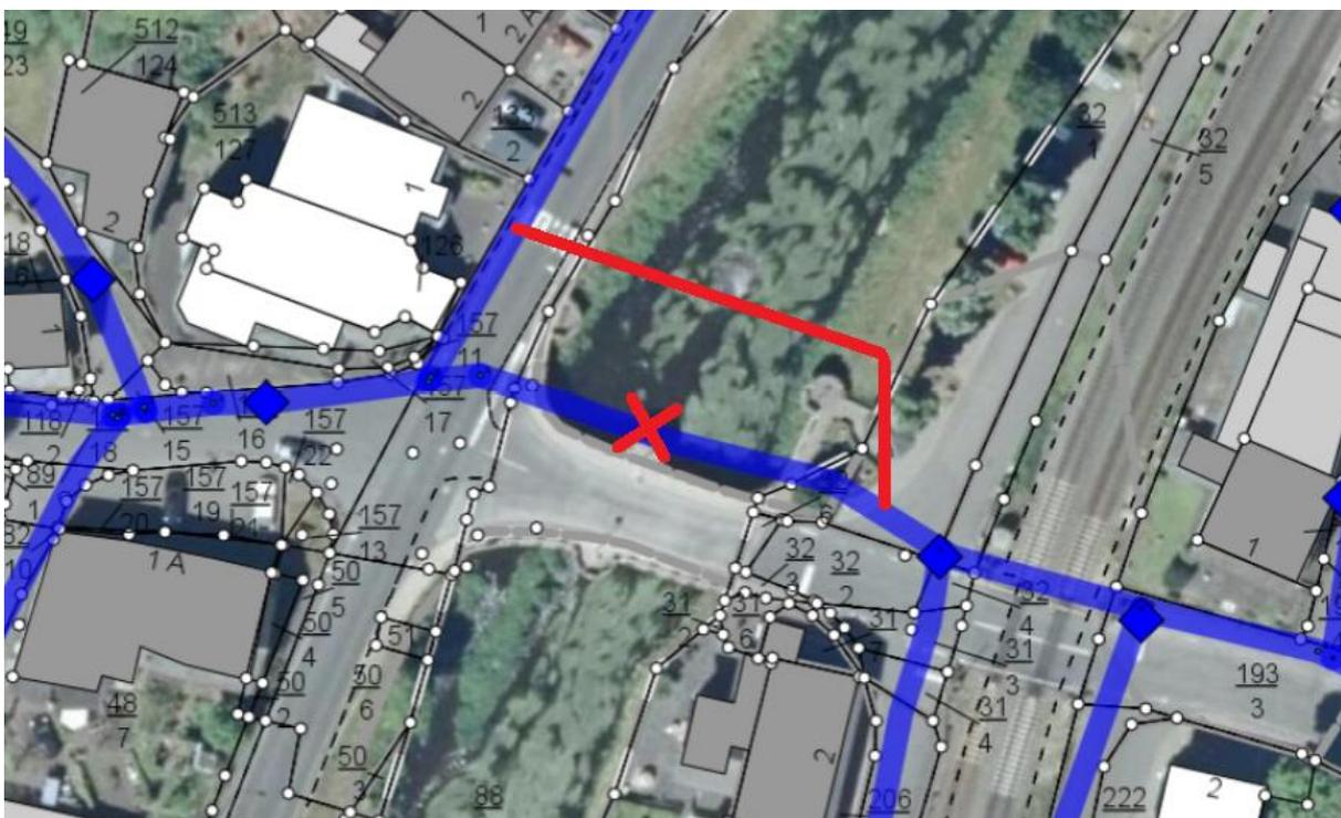
Es ist geplant, die neue Wasserleitung DN 150 in PE-HD unterhalb der Kyll mittels einer verlaufgesteuerten Horizontalspülbohrung zu verlegen. Das Horizontalspülbohrverfahren ist ein gesteuertes Bohrverfahren zur grabenlosen Verlegung von Rohrleitungen. Gängige Einsatzorte sind die Querung von Flüssen, Straßen,
