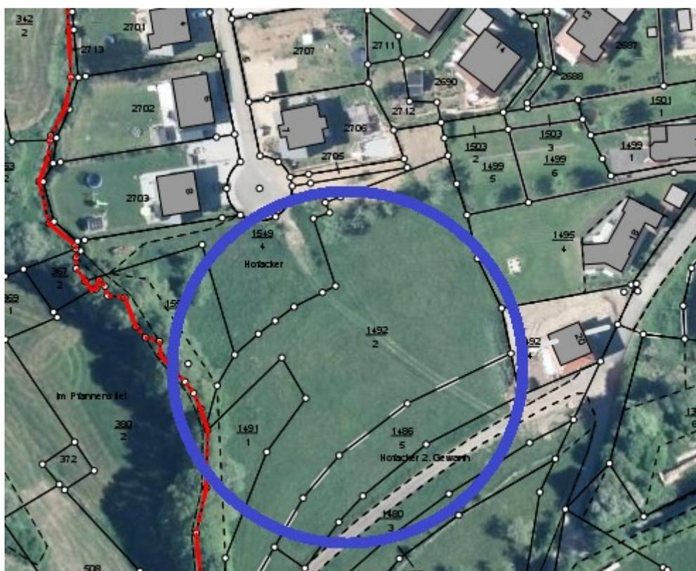
Die Entwässerung des Gebietes ist im Trennsystem vorgesehen. Der Schmutzwasserkanal soll in duktilem Gusseisen DN 250 und der Regenwasserkanal in PVC DN 300, jeweils auf einer Länge von rd. 100 m, verlegt werden. Durch die topografische Lage des Gebietes ist die Ableitung des Schmutz- und Regenwassers im freien Gefälle an die vorhandene Ortskanalisation möglich.
