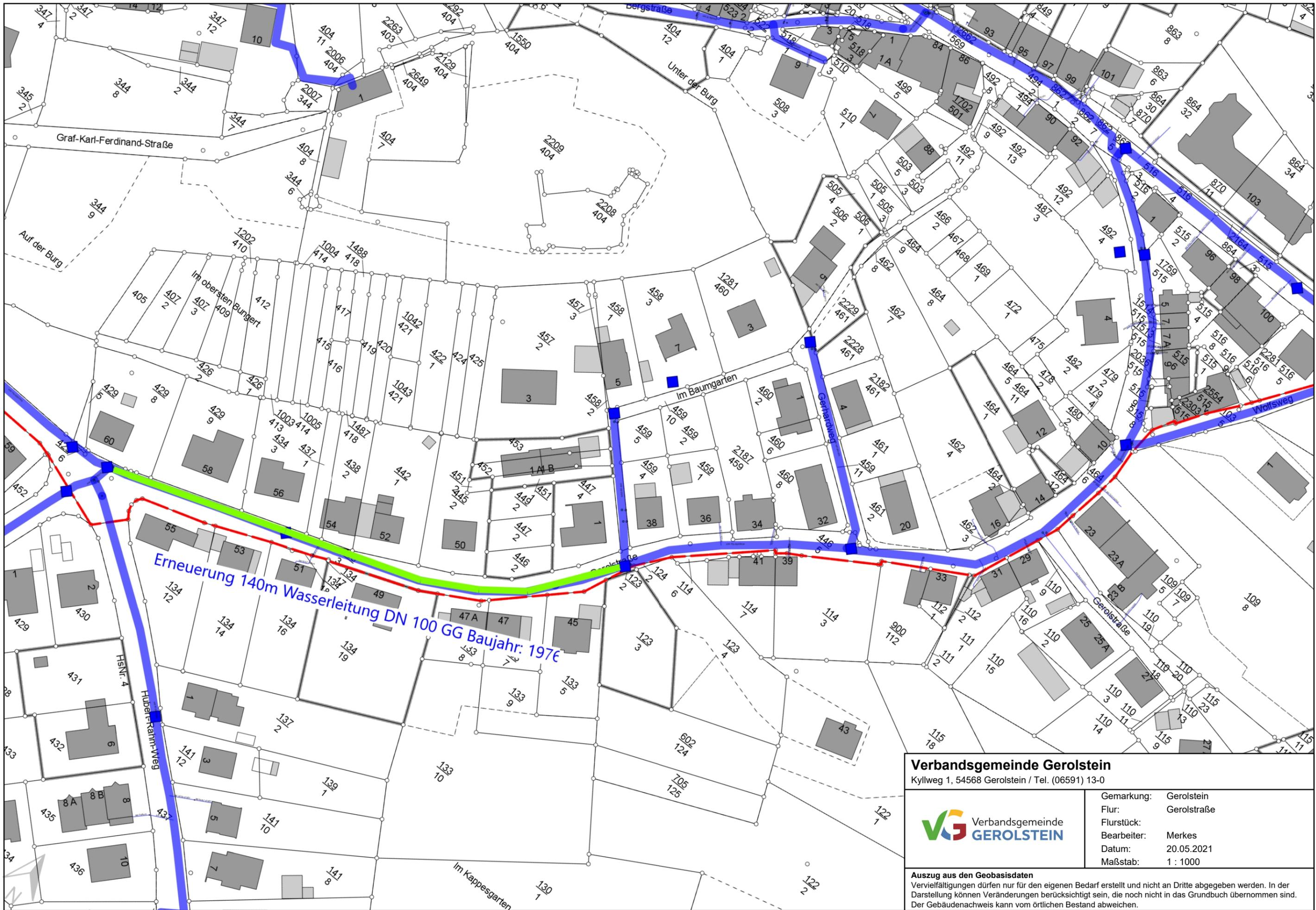
Erneuerung 140m Wasserleitung DN 100 GG Baujahr: 1976
