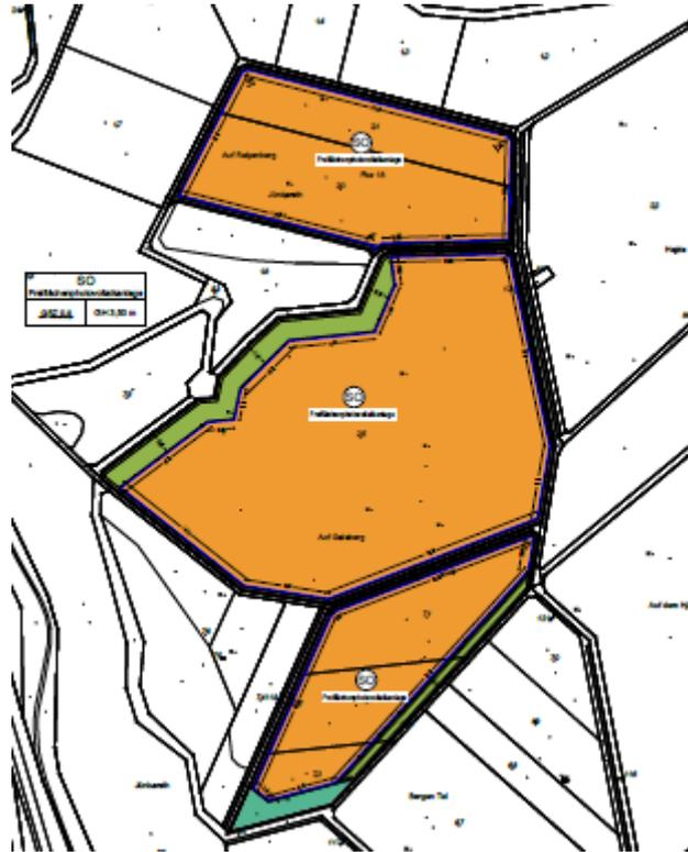
Der Vorhabenträger, die Firma Trianel Energieprojekte GmbH & Co.KG, Krefeld, beabsichtigt auf einer Fläche von 14,27 ha in der Gemarkung Jünkerath die Errichtung und den Betrieb einer Photovoltaik-Freiflächenanlage - mit einer Nennleistung von bis zu 17 MWp - einschließlich der erforderlichen Nebenanlagen und Erschließungswege.
